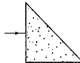
360. В стеклянной пластине имеется воздушная полость в форме трехгранный призмы (см. рисунок). На одну из граней из стекла падает световой луч. Каким будет дальнейший ход луча?
